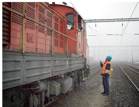
A tolatómozdony vezetője csak akkor indíthatja el mozdonyt, ha a mozgás megkezdésére a tolatásvezetőtől előszóval engedélyt kap.
