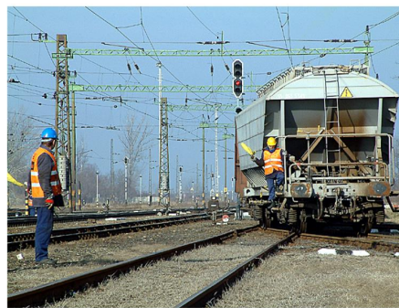
vagy ha a végzendő munkáról történt előzetes tájékoztatás után a tolatásvezetőtől közvetlenül vagy továbbítás útján jelzést kap.
