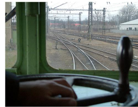
Ha a látási viszonyok lehetővé teszik: a tolatószemélyzet a váltóra haladás előtt kötelesek megfigyelni a váltójelzését, ha nincs a váltónak váltójelzője, akkor a váltó állását.
